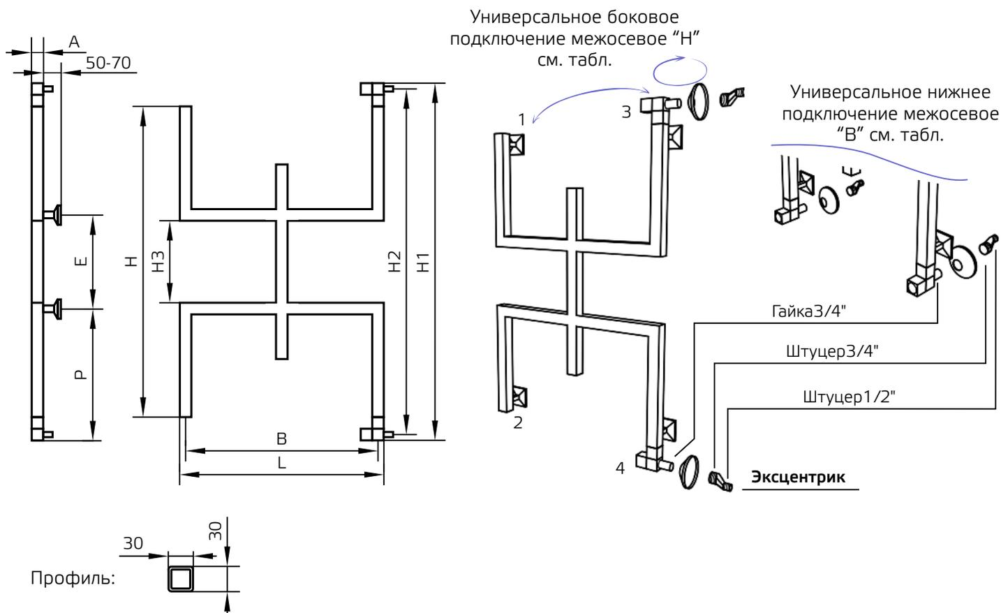
\*При универсальном подключении с проходными уголками или угловыми регулируемыми вентилями комплектующие 1, 2, 3, 4 можно переставлять местами.
